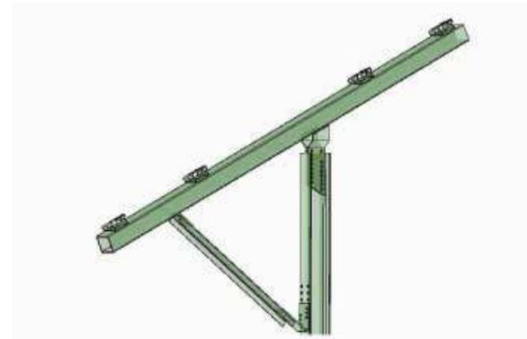
Durch den axial drehbar gelagerten Sparren tritt jeder Pfosten als 2-wertiges Lager auf. Dadurch wird statische Un- bzw. Überbestimmtheit vermieden und das entstehende Tragwerk lässt sich an nahezu jede Geländeform anpassen. Nach dem steifen Verbinden mit den Aluminium-Pfetten wird aus der Konstruktion ein statisch bestimmtes und widerstandsfähiges Tragwerk.
